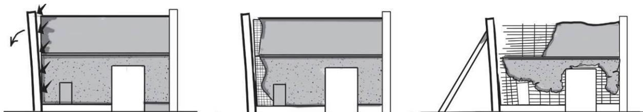
Décollement du pignon par manque d'entretien, infiltration de pluie, craquellement du torchis formant l'enduit extérieur
